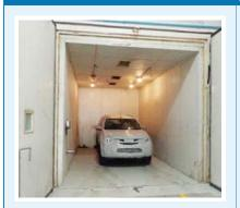
Test Chamber Size : 6 m x 3 m x 3 mTemperature Range :  $-20^{\circ}\text{C}$  to  $70^{\circ}\text{C}$
